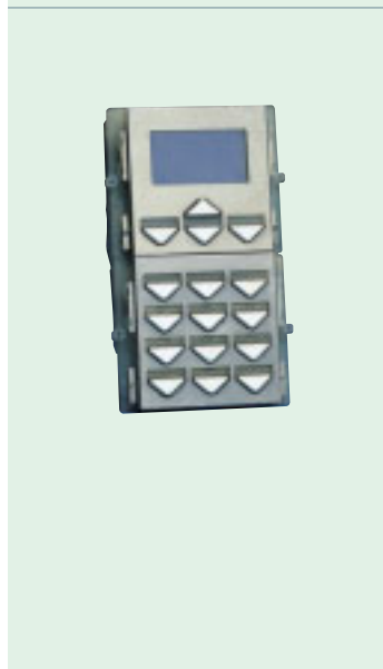
3340 Módulo digital de chamada completo de rubrica electronica. Completo de display LCD gráfico 128x64 dots, teclado 16 botões retro iluminadas com LED azul. Funciona também como chave electronica com código. É completo de módulo rubrica porta nomes electronica, que memoriza 400 nomes de utentes. O escorrimento dos nomes é feito agindo em dois botões de procura ou marcando directamente a inicial do nome. Uma vez visualizado o nome do utente desejado é suficiente carregar no botão de chamada. Também é possível enviar a chamada digitando directamente o código do utente. A programação dos utentes é feita de maneira simples através de um programador art. 1230 ou com o software para PC art. 1249. Dimensões: 112x180x40 mm
