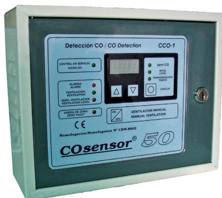
Las centrales COsensor CCO-1 constituyen un equipo electrónico capaz de detectar en todo instante la presencia de monóxido de carbono (CO) en un local (parking, taller, túnel,...) y medir su concentración exacta, expresada en partes por millón. Así mismo, el sistema es capaz de pilotar una extracción de humos (ventilación) o disparar una alarma, dependiendo del nivel de concentración de CO detectado.
