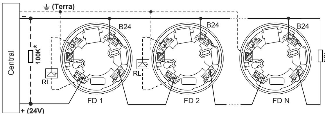
**\*ATENÇÃO:** Quando o módulo EOL é só um capacitor é obrigatório conectar um resistor de 100K paralelamente ao início da linha.
